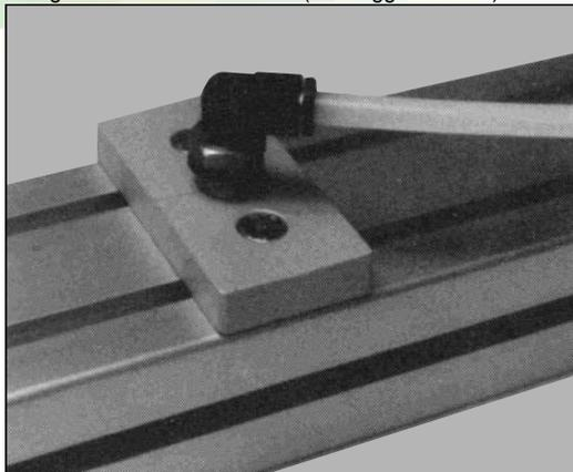
Esempio di presa d'aria di testa
